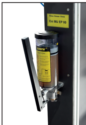
Engrasador manual centralizado.
