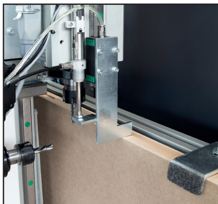
Palpador electrónico para un preciso control en los mecanizados de pernios/bisagras en las puertas.
