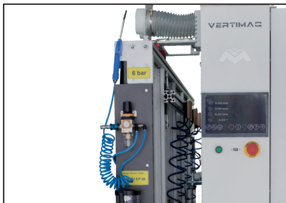
Entrada de aire y soplador de bajo consumo para eliminación de polvo y partículas.
