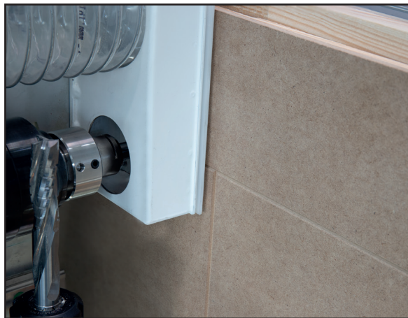
Palpador flotante para mecanizados decorativos.
