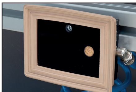
Ventosas para la correcta sujeción de puertas sin dañarlas.
