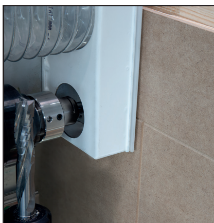
Palpador flotante para mecanizados decorativos.
