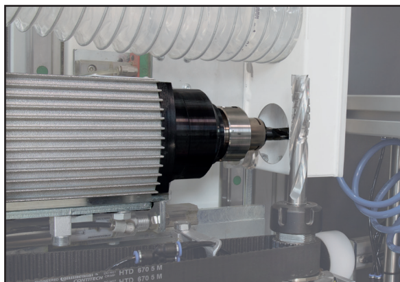
Motor fresador que realiza fresados frontales, orificios de maneta, abertura de vidrieras y ranurados decorativos.
