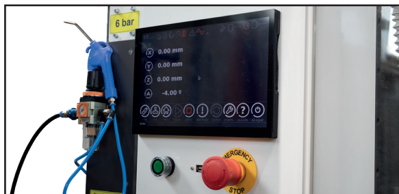
Pantalla táctil con macros para un rápido y sencillo funcionamiento.
