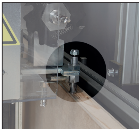
Palpador electrónico para un preciso control en los mecanizados de pernos/bisagras en las puertas.
