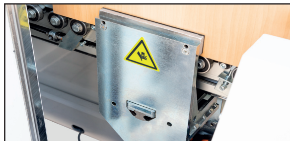
Pinza de agarre. Un elemento esencial para garantizar la inmovilización de la pieza.
