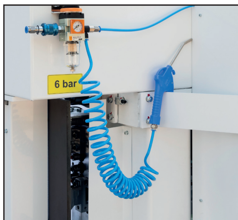
Entrada de aire y soplador bajo consumo de aire y eliminación de polvo y partículas.
