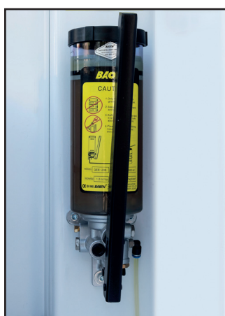
Engrasador manual centralizado.
