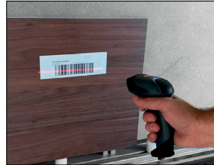
Leitor de código de barras para garantir o carregamento correto do programa e reduzir os erros.
