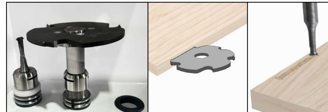
Sistema opcional de lamelo , o opcional inclui uma serra para perfurar lamelos nas faces laterais e uma fresa para os lamelos frontais, além de macros pré-configurados que facilitam a programação no CNC. Com isso, é possível criar encaixes precisos e invisíveis de maneira ágil e repetível, sem necessidade de programação manual complexa
