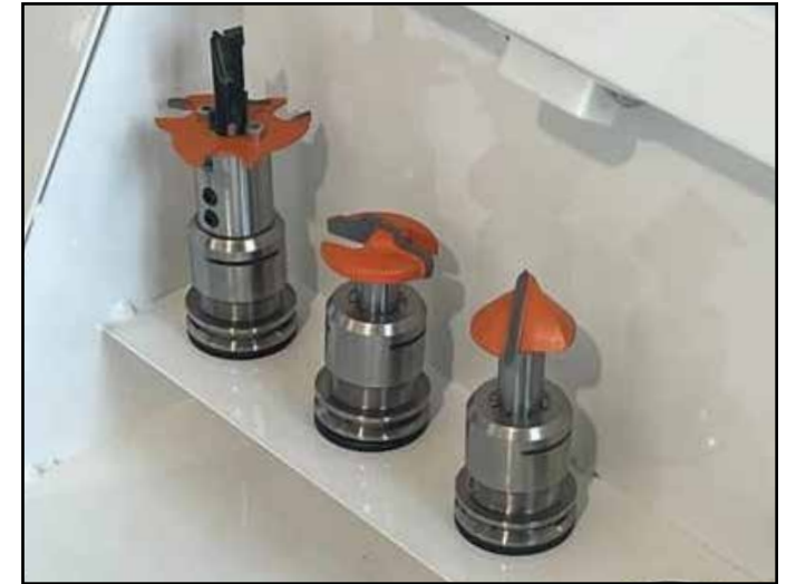
Fresador con cono ISO intercambiable: incluye 4 conos (1 con motor + 3 en un almacén cerrado sin herramientas).
