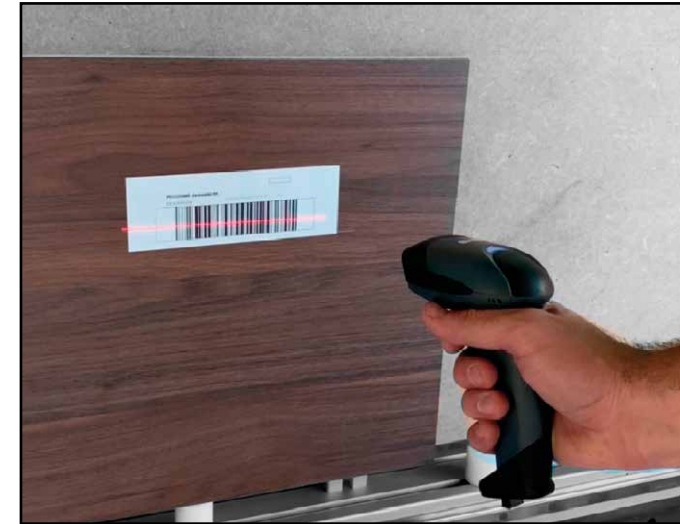
Pistola lectora de códigos de barras para garantizar la carga correcta del programa y reducir errores.
