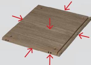
Mecanizado de armarios CNC 6 lados en una sola pasada
